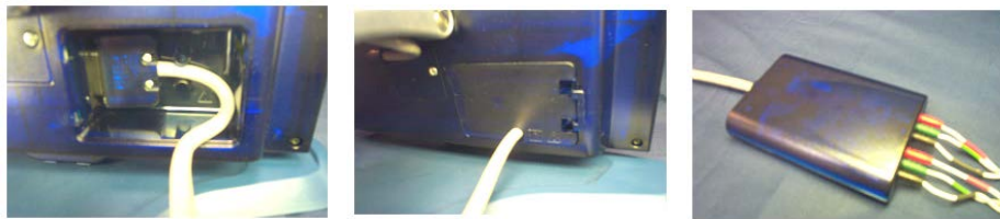
图 4.7：连接 MEP Pod
